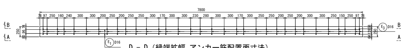
D - D (縁端拡幅 アンカー筋配置面寸法)
