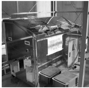
設置された生ごみ処理機
