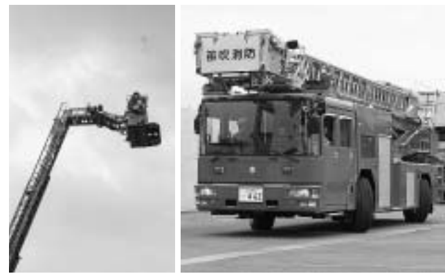
更新されたはしご付消防自動車(右)とはしご使用時に屈折する先端部
