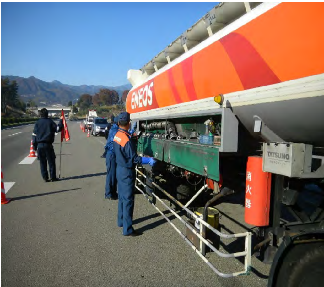
警察と合同での移動タンク貯蔵所路上検査状況
